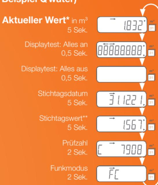
\* Wasserzähler werden zum Stichtag nicht auf Null zurückgesetzt. Sie zeigen den Verbrauch seit Einbau des Messgerätes an.
